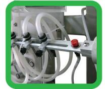
Utiliza bomba Peristáltica y sistema de Tiempo Presión para dosificar un rango amplísimo de viscosidades a volumen constante. El producto fluye a través de manguera siliconada esterilizable, y una mínima cantidad de tubería de acero inoxidable 316 L, con acabado sanitario. Las piezas en contacto con el producto son compactas y caben fácilmente en autoclave.
